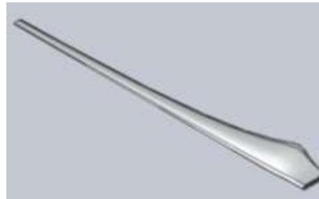
Figura 5 Modelo tridimensional del aspa 2 obtenido en Solidworks.
